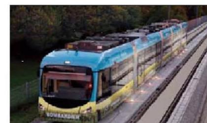
图 14 感应式供电试验线路
